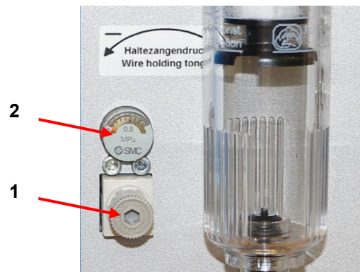
Bild / Picture 3: Einstellung Drahthaltezege / Adjustment Wire Holding Tongs
