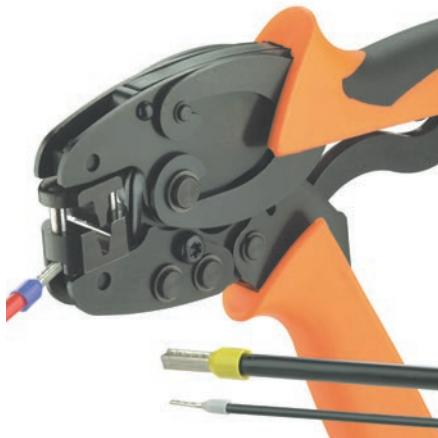
Crimpwerkzeug für Aderendhülsen (nach DIN 46228 Teil 1 und 4) mit und ohne Kunststoffkragen. Drehbares Gesenk für die Einführung von vorne oder seitlich.
